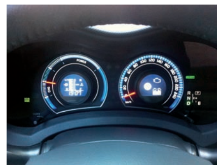
La esfera a la izquierda del velocímetro indica el estado de carga de la batería. Dentro de ella está situado el nivel de la gasolina.
