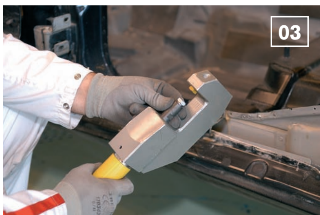
03 Montar la buterola para preparar la superficie para el nuevo remache.
