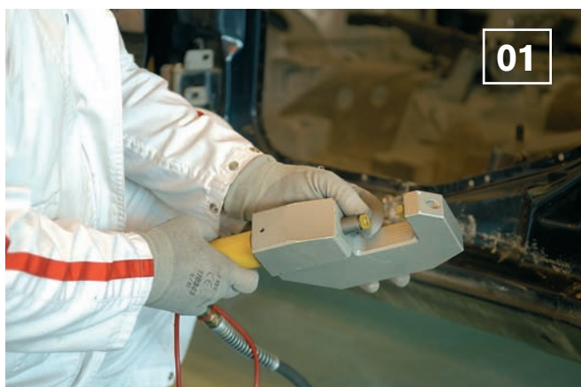
01 Montar en la remachadora la buterola adecuada para retirar el remache. La posición de las buterolas debe ajustarse siempre según el espesor de las piezas.
