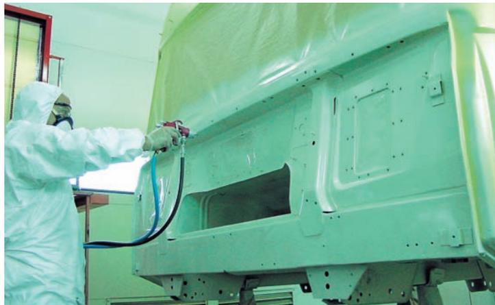
*Pintado con sistema de alimentación por depósito externo*
