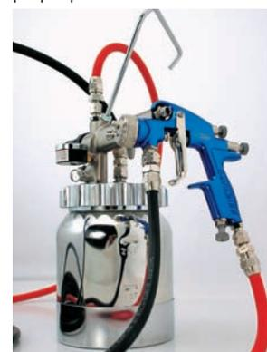
*Equipo aerográfico con depósito de presión*
