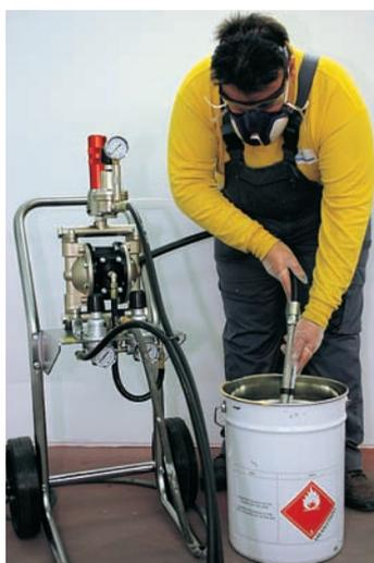
*Utilización de bomba con depósito externo*
