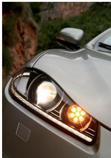
Detalle de la luz diurna e intermitentes LED y de los faros bi-xenón HID.
