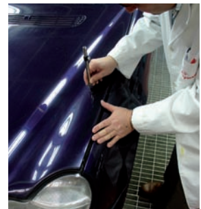
Prueba de dureza sobre un barniz cerámico
