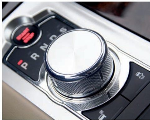
El cambio automático ZF de ocho velocidades realiza los cambios de marcha en tan solo 200 milisegundos.
