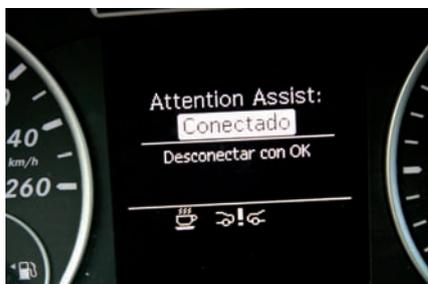
El **Attention Assist** detecta si el conductor está cansado o tiene sueño tras analizar el parpadeo, la mirada, etc.
