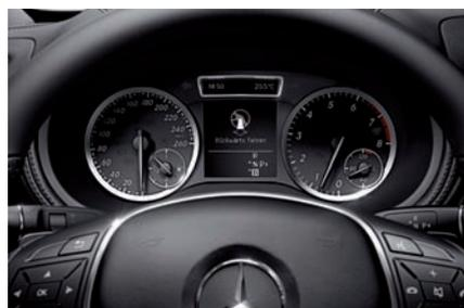
En el cuadro de instrumentos se informa cuando está actuando el sistema de aparcamiento automático. Es el volante y la flecha de la imagen, entre el velocímetro y el cuentarrevoluciones.
