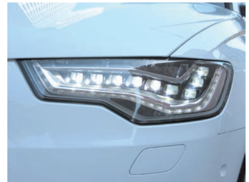
Cuatro LED de un chip y cinco chips generan las luces de cruce.
