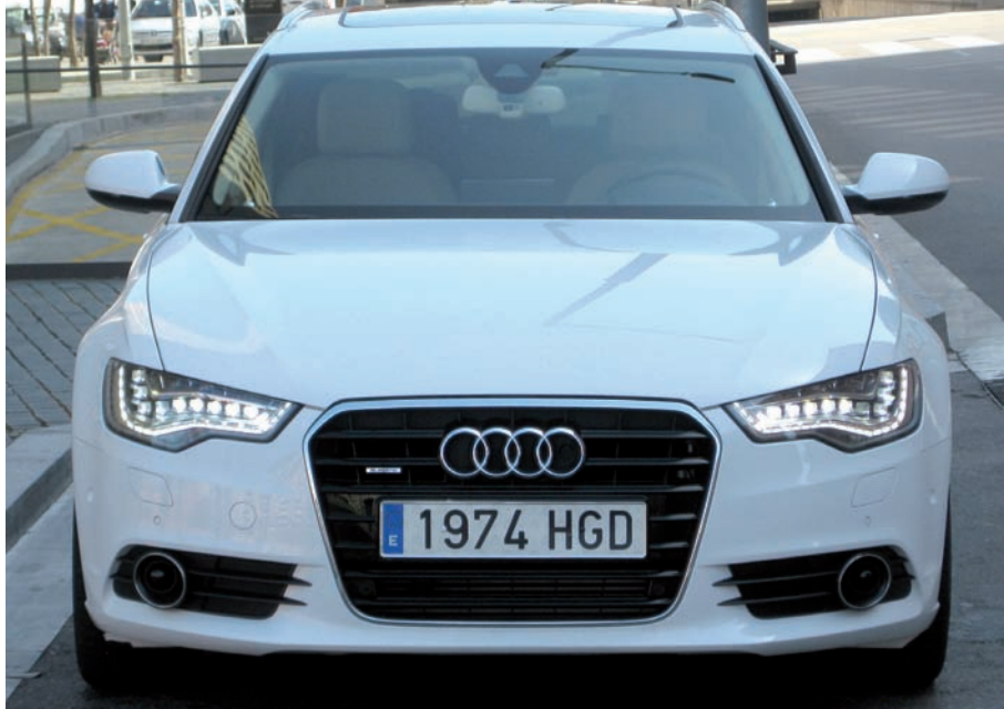
En el Audi A6 se pueden elegir tres sistemas de iluminación: de lámparas halógenas, de faros de xenón plus y con tecnología LED. Este último es el más avanzado.
