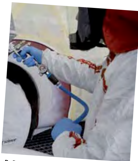
DuPont recomienda aplicar una imprimación fosfatante porque aporta una mejor adherencia y aísla el sustrato del aparejo.
