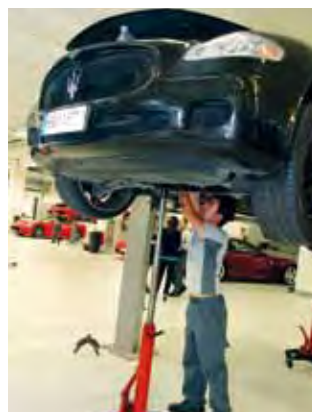
La seguridad es una norma fundamental. Un modelo en el elevador tiene dos columnas para proteger al operario.
