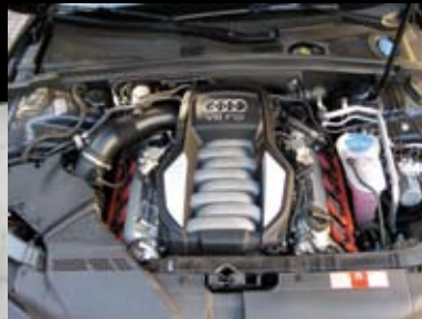
El sistema de inyección FSI aporta una alta compresión y una mezcla optimizada. El resultado es que el S5 4.2 FSI entrega 354 CV de potencia y un par máximo de 440 Nm a partir de 3.500 r.p.m.
