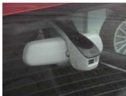
Los componentes del sistema Audi Lane Assist, una cámara en blanco y negro y un ordenador de alta velocidad, están situados sobre el retrovisor interior.
