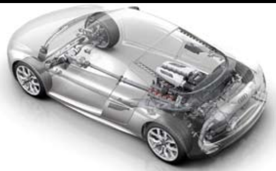
Radiografía del R8. Podemos apreciar la disposición del motor, en posición central trasera.
