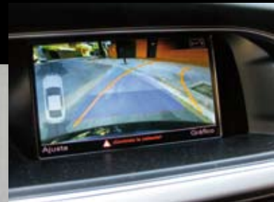
El S5 se puede equipar con el Audi Parking Advanced, un sistema de ayuda al aparcamiento de última generación que recurre a una cámara de última generación y que es capaz de indicar, mediante líneas, cómo se debe realizar la maniobra de aparcamiento.
