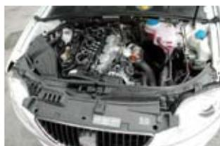
La nueva berlina de SEAT estrena el motor 2.0 TDI con Common Rail y DPF con hasta 170 CV. Va montado en longitudinal.
