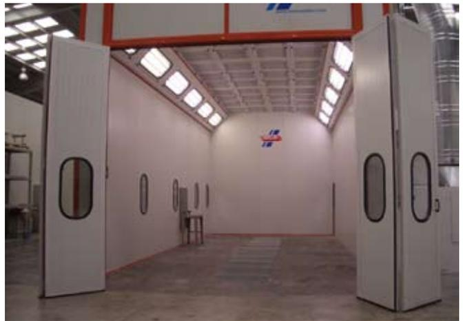
Mercury Dos ofrece varios modelos de cabinas de pintura como el de la imagen. Su última novedad es el modelo CAM, una cabina presurizada y atemperada con flujo de aire vertical.
