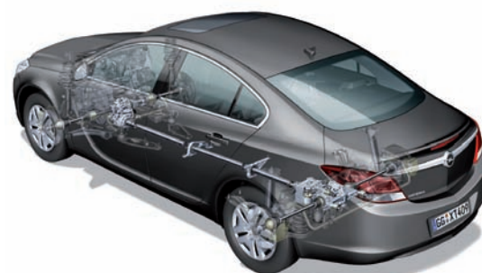
Sistema de tracción total Adaptative 4x4 en forma de radiografía. El control electrónico del embrague es de Haldex.
