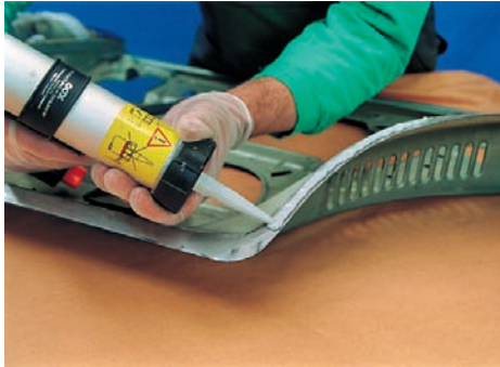
Aplicación de selladores
