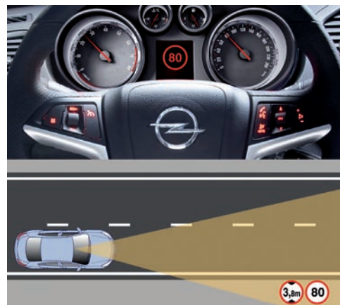
Podemos apreciar como en el salpicadero se muestra el límite de velocidad que fija la señal de tráfico. Es el sistema Opel Eye.
