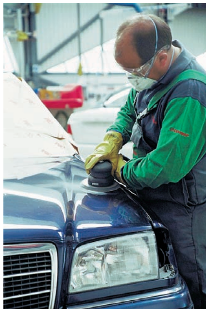
Lijado de pintura
