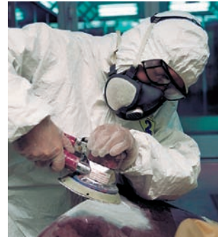
Lijado de poliéster con fibra de vidrio
