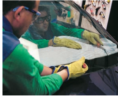
Desmontaje de la luna del parabrisas
