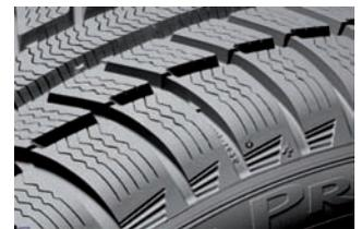
En la imagen podemos apreciar el elevado número de laminillas en los tacos, factor clave para que los neumáticos de invierno ofrezcan una mayor adherencia en suelos nevados, helados o húmedos.
