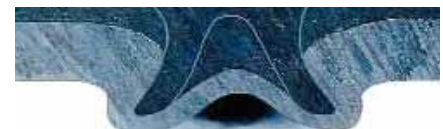
Sección de un remache autopercutor
