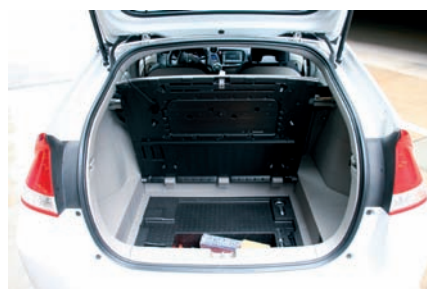
La batería de alta potencia se ubica debajo del maletero para bajar el centro de gravedad y así mejorar el comportamiento del Insight.
