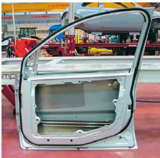
Hueco de accesibilidad de la puerta
