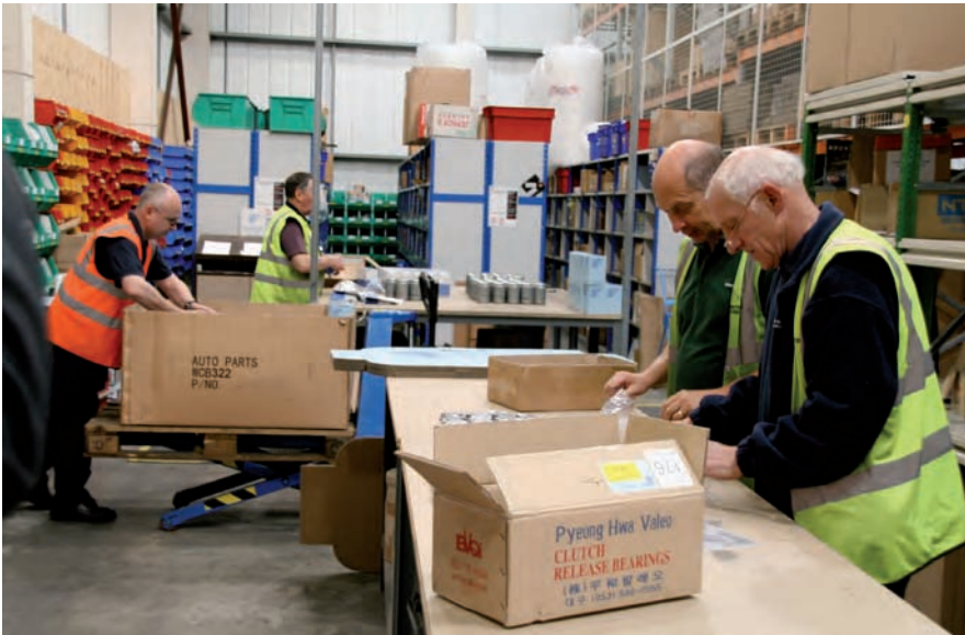
Zona de kits dentro del almacén. Operarios buscan las piezas por separado y las empaquetan en una caja propia. Suelen ser kits de freno o de embrague.
