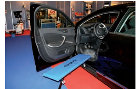
Bancada especial para trabajar debajo del salpicadero, una de las primicias de Ikotec.
