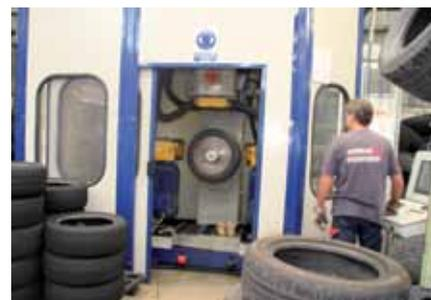
Zona de raspado de la banda de rodadura. Los neumáticos renovados Insa Turbo cumplen la misma norma de calidad que los nuevos, la E9.
