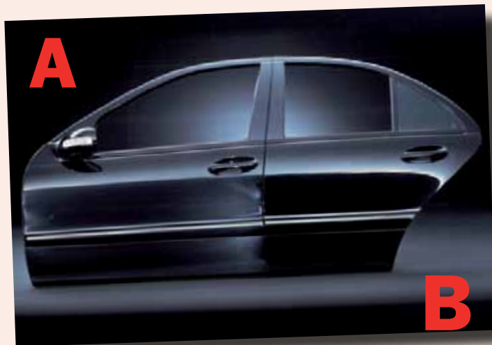
Resultados de la prueba de arañazos producida por un lavado automático: A: BARNIZ CONVENCIONAL B: CERAMICLEAR D8105
