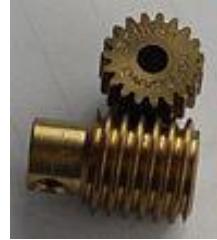
Mecanismo tornillo sin fin
