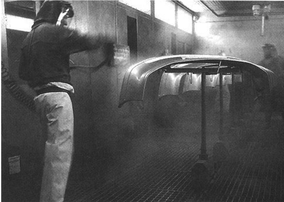
Las fotografías que se adjuntan muestran imágenes de una cadena de pintado de componentes de plástico instalada en una fábrica de automóviles para la aplicación de capas de recubrimiento diluibles en agua en forma de agente adhesivo, imprimación y esmalte base.
