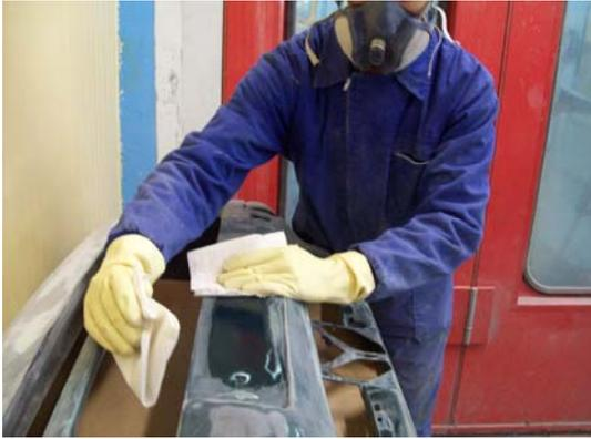
**5. Limpieza:** Una buena limpieza es fundamental para cualquier proceso ya sea de enmasillado, antes del flameado o pintado. Si no se realiza adecuadamente puede ocasionarse gran cantidad de defectos en el acabado final.
