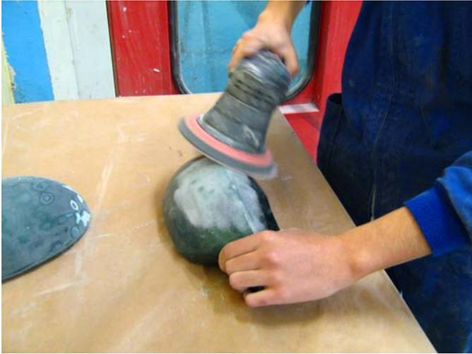
**1. Lijado del retrovisor:** Este proceso consiste en retirarle toda la pintura al retrovisor, para poder posteriormente realizar el aparejado del mismo.
