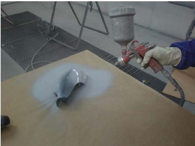
**3. Aparejado:** El aparejo es un compuesto bicomponente formado por aparejo más catalizador; este tipo de aparejo es de alta elasticidad. La finalidad del aparejo es preparar una base uniforme con un buen recubrimiento para favorecer a la pintura.
