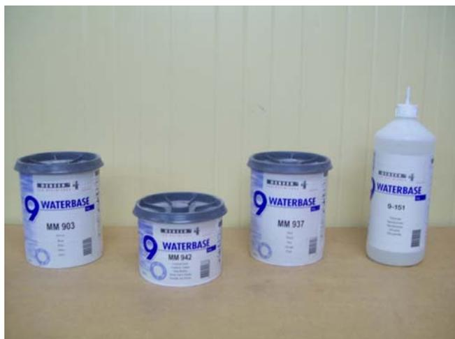
La pintura que se utiliza para plásticos es la misma que se utiliza en chapa, la única diferencia es que se le añaden elastificantes.
