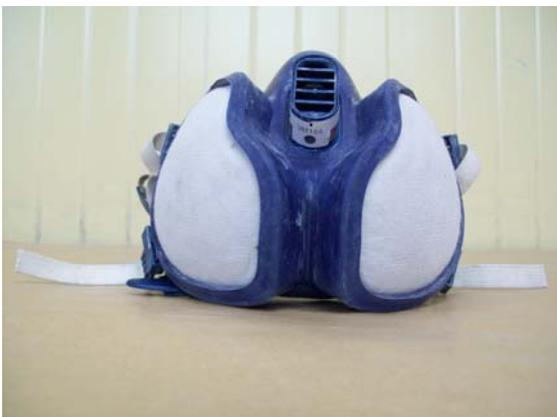
Los equipos de protección respiratoria, son uno de los mas importantes en el área de pintura; este tipo de mascarillas llevan en su interior carbono activo, una sustancia que se encarga de purificar el aire que se inhala al respirar vapores de pinturas o disolventes.
