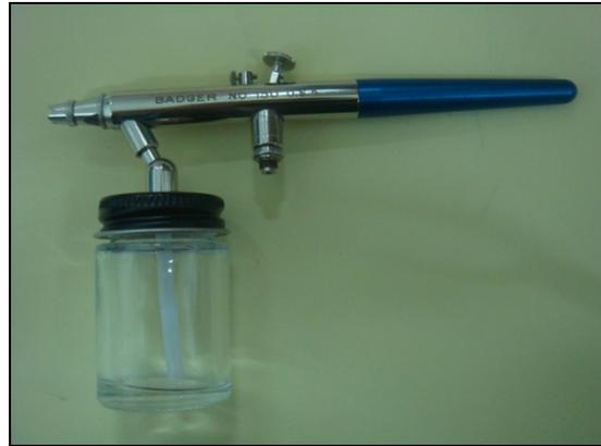
El aerógrafo de mezcla externa atomiza la pintura fuera del propio aparato; es el modelo más básico, ya que en realidad es una pistola pulverizadora. Se utiliza principalmente para cubrir fondos grandes superficies y para la rotulación con plantillas.
