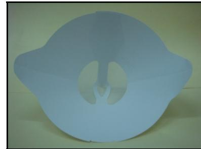
Cada tipo de pintura necesita un filtro adecuado a sus características, ya que si por ejemplo se trata un bicapa metalizado con un filtro que tenga una malla excesivamente fina, puede suceder que los pigmentos metálicos no lo atraviesen. Para evitar esto se debe atender a las especificaciones del fabricante.
