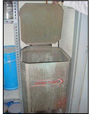
Aunque existen diferentes modelos en el mercado, básicamente, todos llevan una bomba activada de forma neumática, que absorbe el disolvente de un depósito estanco y lo hace circular a presión de unos conductos, que proyecta el disolvente hacia un soporte donde es colocada la pistola ( o pistolas ).
