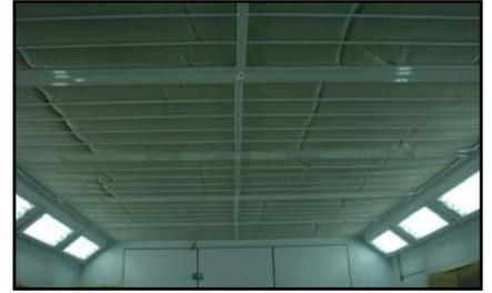
**Filtros:** Los filtros de las cabinas han de ser resistentes a las altas temperaturas y no ser inflamables. Normalmente las cabinas constan de los siguientes filtros:
