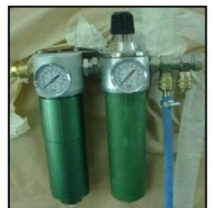
\* **Manómetros** Cada proceso y cada producto requieren unas condiciones de aplicación diferentes, entre las que se incluyen la presión de aire, por ello es preciso instalar llaves de paso con manómetros para regular dicha presión, y ajustarla a las especificaciones del producto para su posterior aplicación con la pistola aerográfica, pistola de soplado o herramientas neumáticas.
