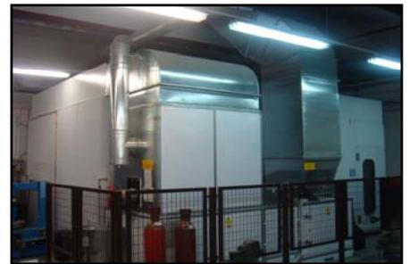
**Iluminación:** La iluminación en una cabina es un factor muy importante a la hora de aplicar cualquier producto. Esta iluminación se produce gracias a lámparas que imitan la luz del día. Se colocan en el techo y en las paredes formando un ángulo.
