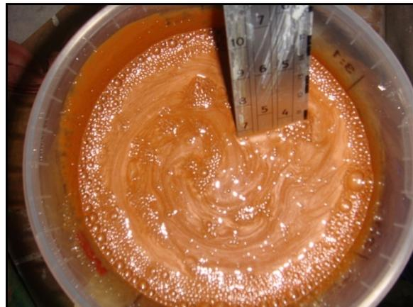
Generalmente, se utilizan reglas de proporcionales para medir el volumen. Por ejemplo: para medir 300 ml de producto, 100 ml de catalizador y 100 ml de diluyente, se expresaría: 3:1:1. Como las mezclas se realizan en proporciones de volumen, una simple regla graduada sirve, siempre que el recipiente contenedor sea cilíndrico. También existen reglas particularizadas a cada proporción, graduadas mediante una serie de líneas, colores, letras, números, etc.
