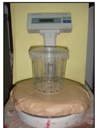
\* **La balanza electrónica de precisión** tiene una tolerancia de  $\pm 0,01g$ . Estas balanzas electrónicas dependiendo del fabricante pueden tener diversas funciones, además de pesar, como restar el peso del recipiente (tarado) para no tener que hacer operaciones matemáticas a la hora de ir sumando las cantidades de productos, o estar conectada a un sistema informático que registre los datos y realice cualquier operación de forma rápida y segura.
