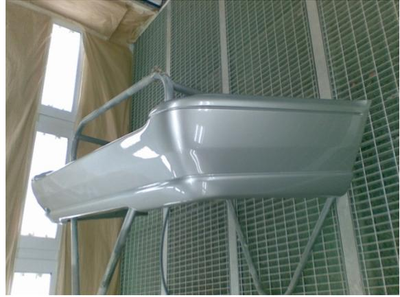
El secado es fundamental, el fabricante nos indica que hay que secar en este caso 30min a 60°, también hemos de esperar un tiempo de condensación, es decir inmediatamente después de pintar no puedes poner el horno directamente, tienes que esperar el tiempo establecido por el fabricante de pintura para evitar posteriores defectos en la pintura como son los hervidos, en este caso 10min.
