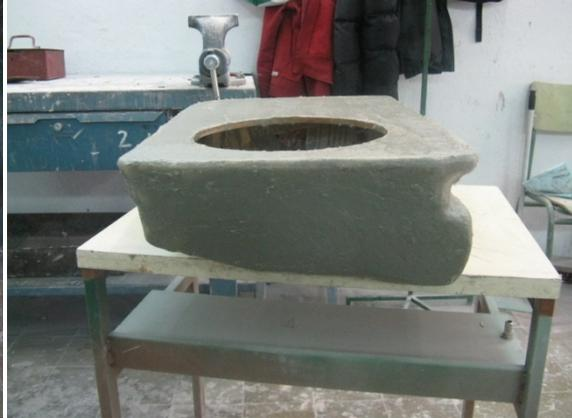
Esperamos a que la masilla seque completamente y lijamos de nuevo hasta obtener una superficie completamente lisa.
