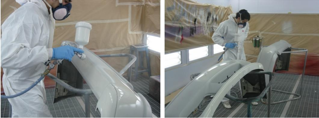
Una vez aparejados esperamos a que se seque completamente y los lijamos al agua con una lija de grano P-800. Encontramos un pequeño desperfecto que rellenamos con masilla tapaporos, monocomponente, adecuada para rellenar microporosidades e imperfecciones menores, crea un soporte sólido para las siguientes capas de pintura.
