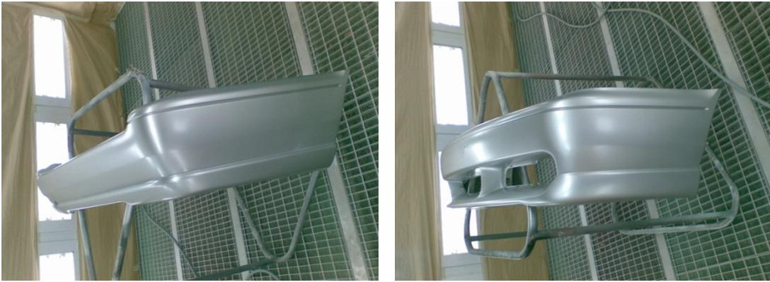
La preparación de la laca la realizamos también como indica el fabricante que es en una proporción de catalizador de 2:1 y con una dilución de un 10%. En este caso utilizamos una pistola RP (mixta) de lacar con un pico de fluido menor que la de pintar, de 1,2mm exactamente, ya que la laca es más fluida incluso.
