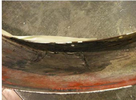
Podemos observar que se encuentra completamente roto. Realizamos un chaflán por la cara interior con una fresa y un rotaliss, para que se agarre la fibra de vidrio que vamos a aplicar.
