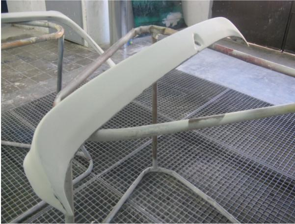
No obstante antes de aparejar es fundamental aplicar imprimación para plásticos o promotor de adherencia sobre el plástico desnudo para que el aparejo agarre sobre el plástico.
