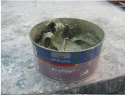
Tras terminar el proceso de lijado desengrasamos bien y aplicamos masilla reforzada con fibra de vidrio para igualar toda la pieza.
