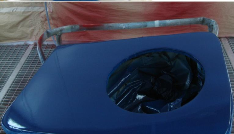
fondo, azul cobalto oscuro. Realizamos la mezcla como hemos detallado en anteriores ocasiones, filtramos la mezcla, llenamos el depósito de la pistola y nos vamos a la cabina con la pieza ya desengrasada y lista para pintar.
