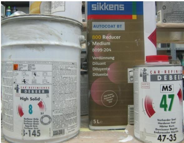
Usaremos un aparejo epoxi, bicomponente de color gris claro, específico para plásticos con un catalizador rápido y le añadiremos diluyente para diluir la mezcla.
