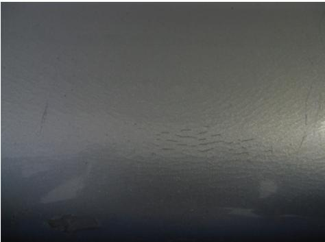
En la parte superior encontramos un defecto en la pintura. La falta de elastificante en la mezcla de pintura causa que al menor impacto la pintura se agriete como se observa en la fotografía. Esto nos indica que este paragolpes ya ha sido repintado alguna vez ya que en fábrica no se comete ningún defecto de pintura.
