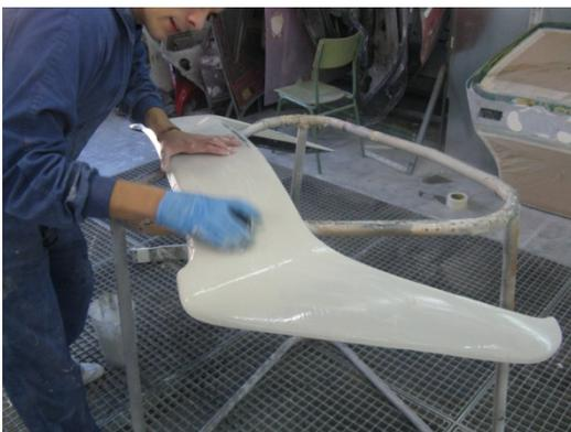
Como el aparejo con el que viene la pieza es de escaso espesor, para su lijado únicamente utilizaremos materiales abrasivos que permitan el lijado al agua, para poder emplear lijas de mayor grano que aquellas usadas en seco y así evitar pasarnos lijando.
