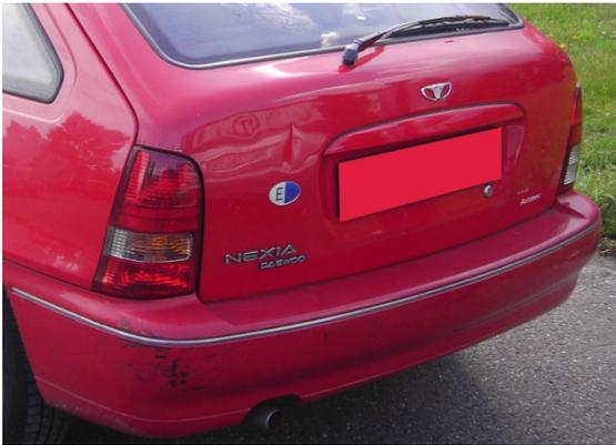
Sin embargo el procedimiento de reparación es idéntico al del Volvo, lijar, enmasillar con masilla específica para plásticos y una vez reparado, aplicar promotor de adherencia en las zonas que quedaran en plástico vivo antes de aparejar.
