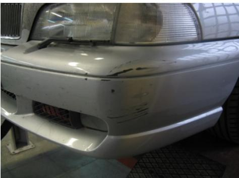
En el paragolpes delantero se observa otro golpe en la esquina derecha, que ha desprendido parte de la pintura y ha causado daños en el propio plástico.
