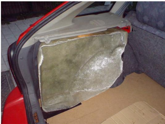
Tras esperar a que esté completamente seco, (tiempo de secado aconsejado por el fabricante 18 - 20 horas), retiramos el molde y lo presentamos en su sitio para comprobar el resultado.
