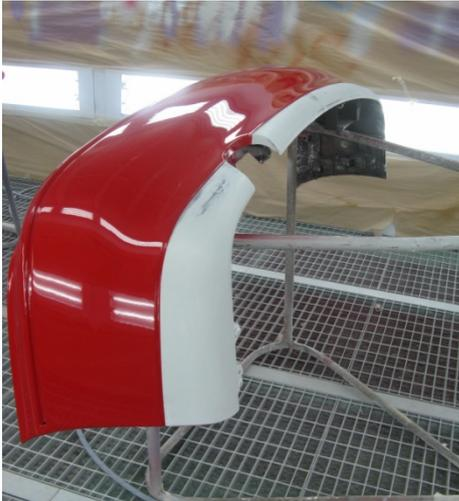
En las siguientes imágenes podemos observar el acabado final de la pieza de la zona pintada en color rojo y como el defecto dicho anteriormente se ha subsanado con la segunda mano de pintura no apreciándose nada.
