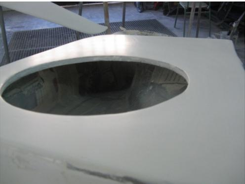
Vemos el acabado que deja el lijar al agua pues solo con ello se llega a apreciar que el aparejo brilla. Ya tenemos lista la pieza para la fase de pintura.
