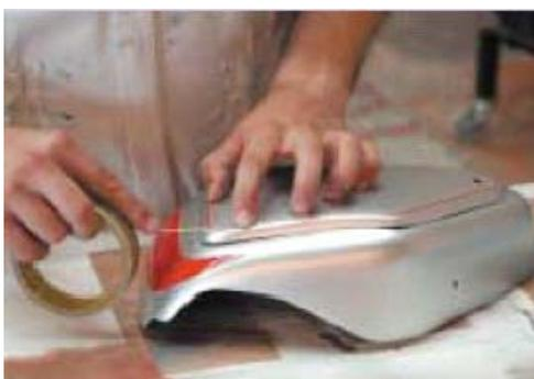
La aplicación de Imprimaciones, pinturas mas barnices, etc, mediante pistolas aerográficas, produce una niebla que hace que parte de estos productos se difuminen y afecten a las zonas próximas, esuciándolas con los conocidos pulverizados.
