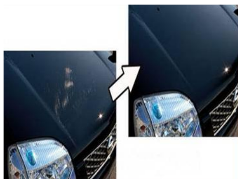
Ilustración 13.- Coche tras realizar una ralladura y después de su autocicatricación.
