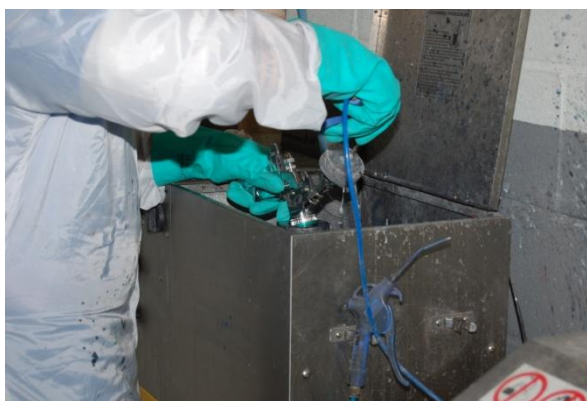
Ilustración 14.- Operario limpiando pistolas en lavadora de pistolas
