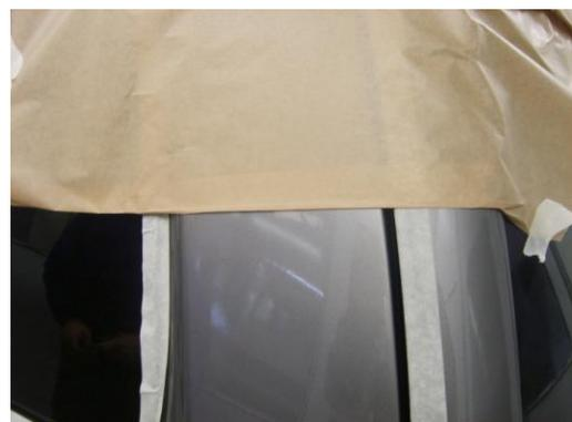
El paso siguiente será proceder a cubrir el vehículo con film plástico, salvo la pieza a difuminar hasta llegar a cubrir hasta la zona del corte donde se ha colocado el papel y la cinta para proteger las demás piezas de manera similar al paso anterior.
