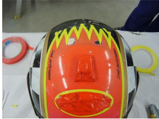
Se coloca un film plástico especial para proteger toda la superficie de posibles pulverizados
