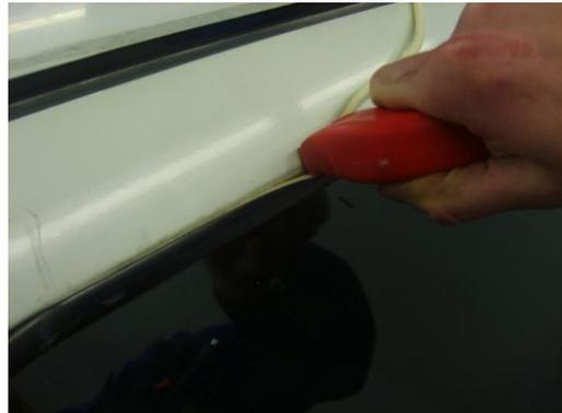
Proceso de enmascarado mediante la utilización de cinta especial para molduras.
