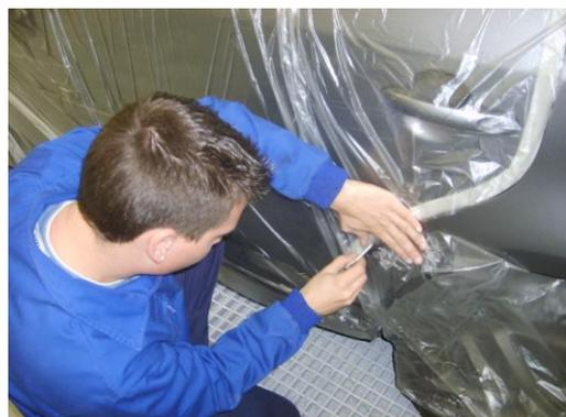
En la pieza a difuminar llegaremos a cubrir hasta la zona del corte donde se ha colocado el burlete y lo sujetaremos a él con cinta.
