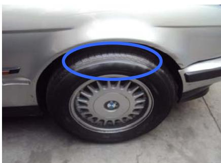
El defecto se produce por un mal enmascarado de la rueda y así se produce la pulverización.
