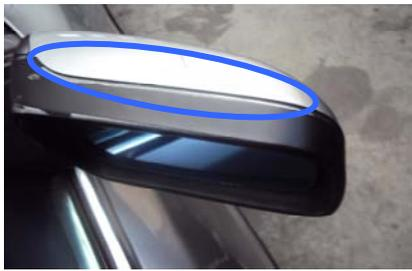
Al perfilar mal el plástico del espejo se a producido una línea de pulverizado.
