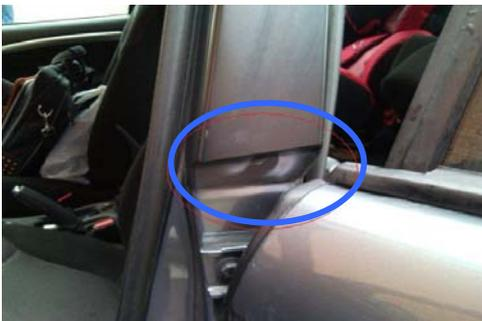
La pulverización se produce por un mal sellado, en el enmascarado y por eso se produce una entrada de la pintura que produce una pulverización.
