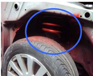
Al enmascarar la aleta, lateral, etc. Dejamos la separación de la rueda y la aleta y se produjo la pulverización sobre la suspensión.
