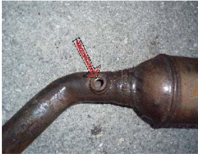
Ubicación Sonda Lambda antes del catalizador.
