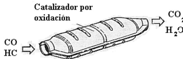
Las prestaciones de estos tipos de catalizadores sobre los gases de escape son difícilmente controlables. Las temperaturas máximas de los gases de escape en los motores diesel no permiten que se funda el monolito cerámico.
