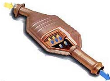
La superficie de este monolito se encuentra impregnada con una resina que contiene elementos nobles metálicos, tales como Platino (Pt) y Paladio (Pd), que permiten la función de oxidación, más Rodio (Rh), que interviene en la reducción. Estos metales actúan como catalizadores, es decir, transforman los gases de escape.
