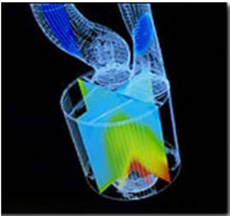
El sistema FAP es activo en todas las condiciones de uso del vehículo y la regeneración pasa desapercibida por el conductor sin alteración de las prestaciones del vehículo. Una regeneración completa dura de dos a tres minutos y se ejecuta cada 400 a 500 km.
