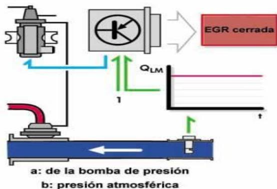
En condiciones normales (sin recirculación de gases de escape) la masa de aire aspirado medida por el caudalímetro, registra una aspiración proporcional al régimen de revoluciones del motor. Para que la unidad de control (ECU) sepa que se está proporcionando la suficiente y adecuada cantidad de gases de escape a la admisión debe acusar una caída determinada en el valor de la tensión entregada por dicho sensor. Hasta no la detecte seguirá inyectando gases de escape.
