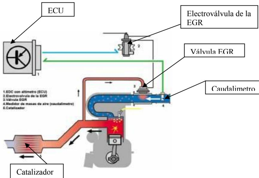
Con la recirculación de los gases de escape se ha conseguido mejorar las emisiones de óxidos de nitrógeno pero, se han incrementado las de monóxido de carbono y partículas.
