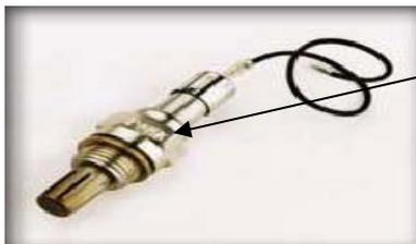
Estructura de una sonda lambda
