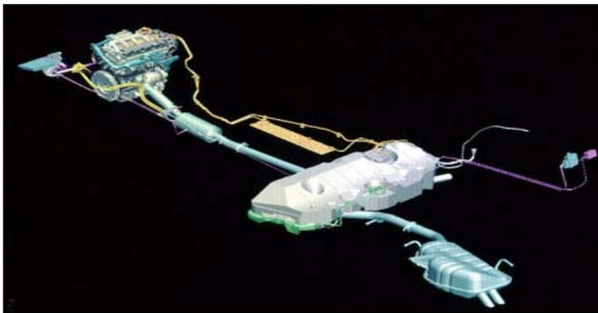
1. Un soporte filtrante de carburo de silicio asociado a un pre catalizador "arriba" y sensores de control de temperatura y de presión.
