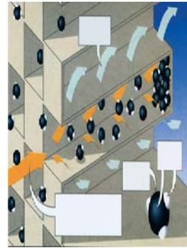
El sistema FAP ha sido desarrollado para ser utilizado en los motores provistos de alimentación por conducto único (common-rail) de los motores HDI. Este sistema de gestión del motor permite un control total sobre la fase de combustión, de esta forma se puede incrementar la temperatura de los
