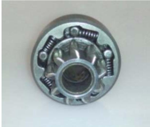
Elemento compuesto por una pista interior u otra exterior, y entre estas dos, por unos cilindros y unos muelles.
