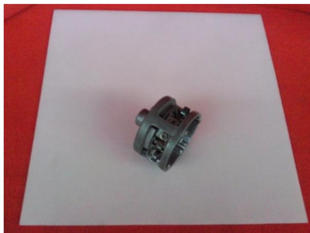
Esta constituido por una pieza de fundición de aluminio, sobre la que se monta un cojinete de fricción de bronce sinterizado, que sirve de apoyo y sobre el que gira el inducido.
