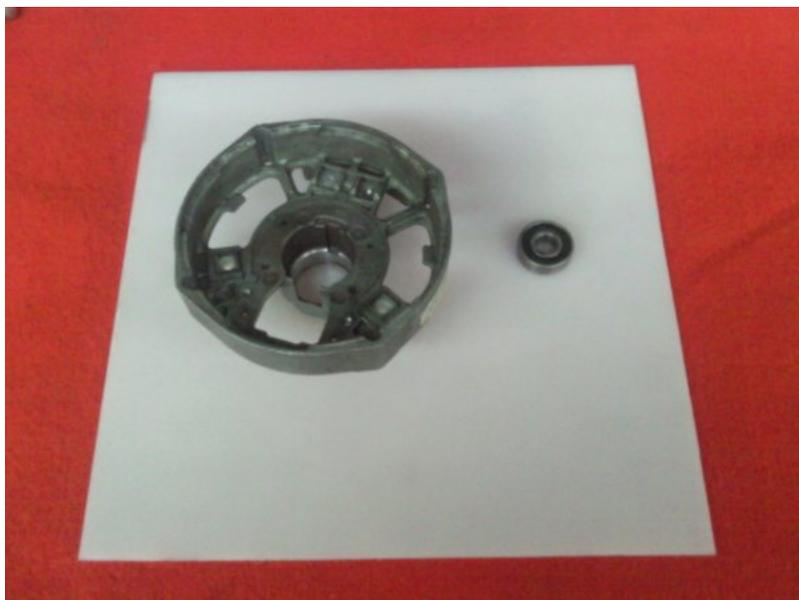
Realizada en fundición de aluminio sobre el cual se monta el porta escobillas, el puente rectificador y el regulador.
