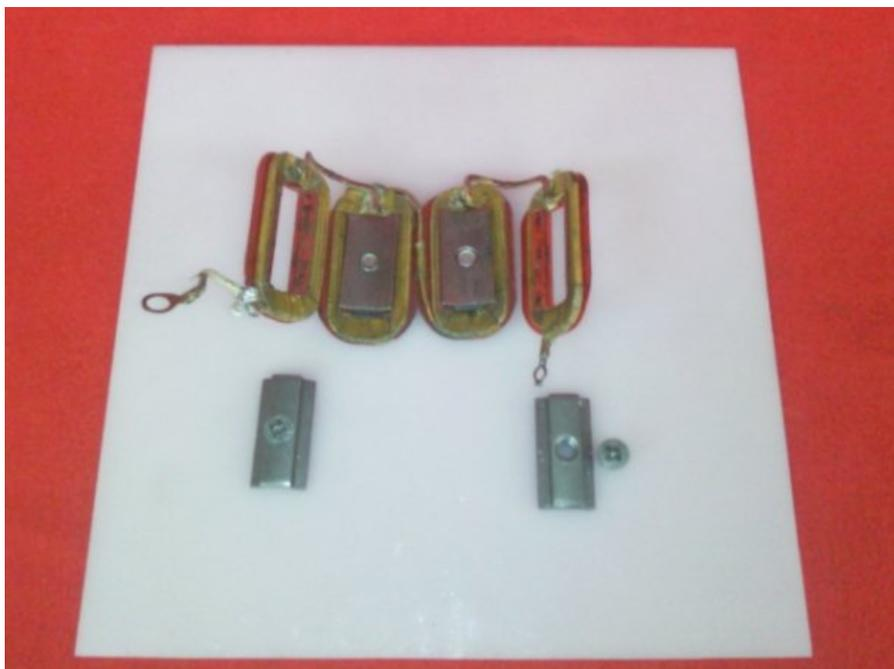
Esta formado por las bobinas inductoras, generalmente realizadas en hilo o en pletina de cobre recocido. Las espiras que forman las bobinas inductoras, van aisladas entre sí, y estas a su vez se aíslan de la carcasa y de las expansiones polares por medio de recubrimientos aislantes.
