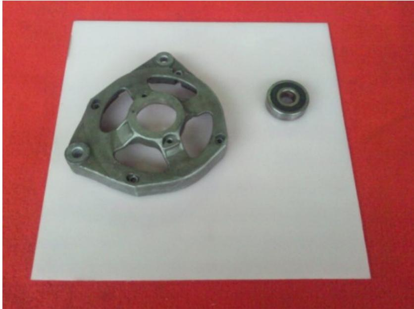
Realizada en fundición de aluminio incorpora los soportes para el anclaje del alternador al automóvil. Contiene el rodamiento sobre el que gira el eje del rotor.
