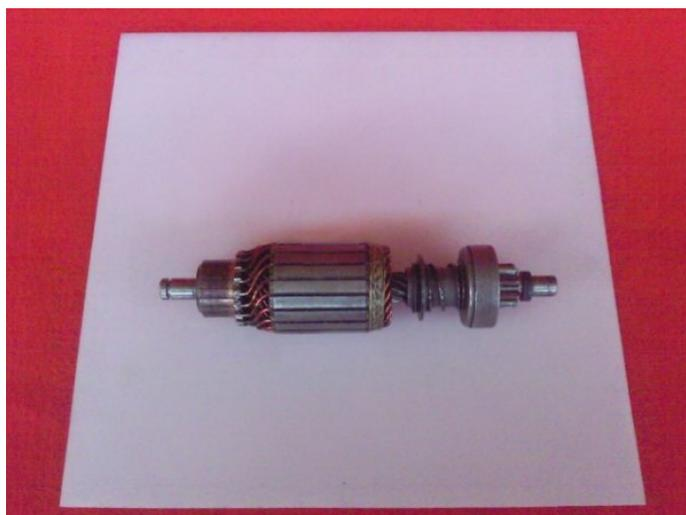
Un eje sobre el cual se encuentra montado un paquete de chapas troqueladas que forman un núcleo o armadura y sobre cuyas ranuras se montan los arrollamientos debidamente aislados.
