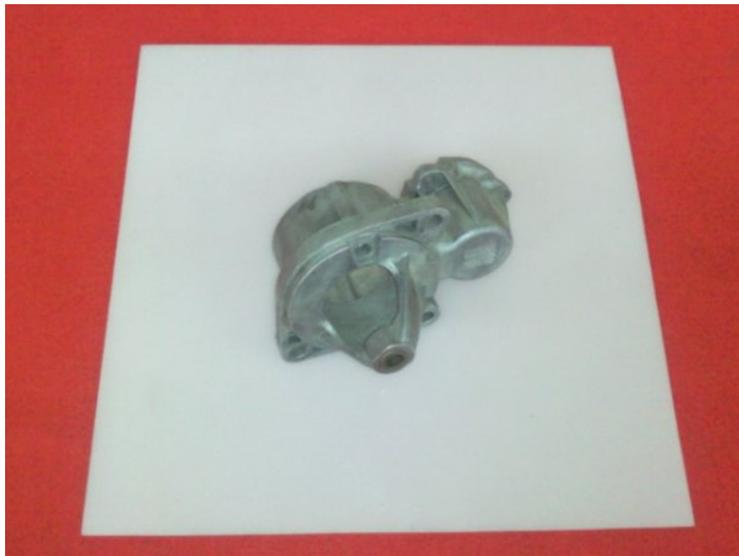
Se trata de una pieza obtenida en fundición de aluminio, en la que va montado un cojinete de fricción en bronce sinterizado, sobre el cual se apoya y gira el inducido, y que cierra el conjunto motor en uno de sus extremos.
