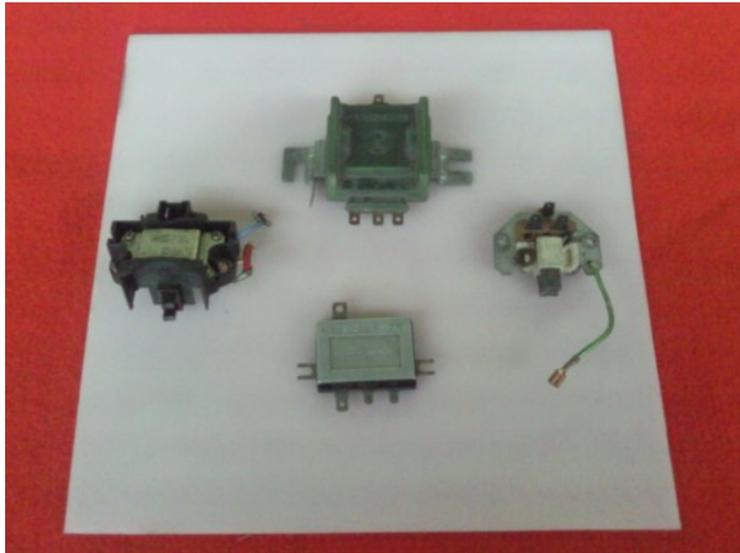
El regulador es un elemento compuesto de componentes electrónicos, que normalmente, va unido al porta escobillas, el cual contiene las escobillas de carbón que son presionadas contra los anillos rozantes del rotor y conducen una corriente de excitación relativamente pequeña hasta el devanado inductor.
