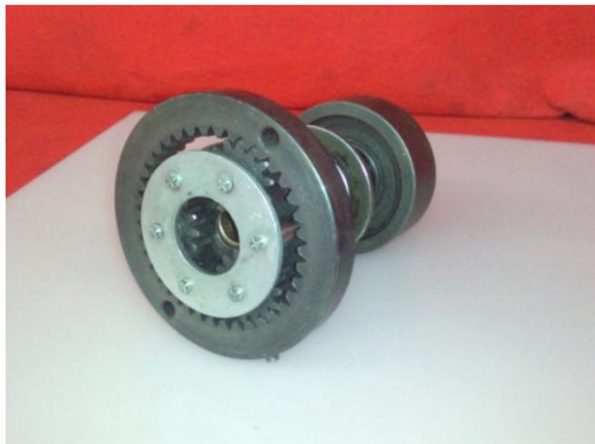
Es un elemento que no llevan todos los motores de arranque, se trata de una reductora, compuesta por una serie de engranajes, llamados satélites y planetarios, los cuales se encargan de hacer una relación de transmisión de desmultiplicación, reduciendo las revoluciones de salida, pero aumentando considerablemente el par de salida.
