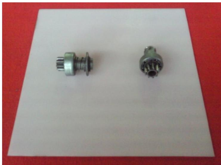
Se trata de un piñón que va apoyado sobre el eje del inducido a través de un casquillo. consta del mecanismo de rueda libre, y piñón de engranaje.
