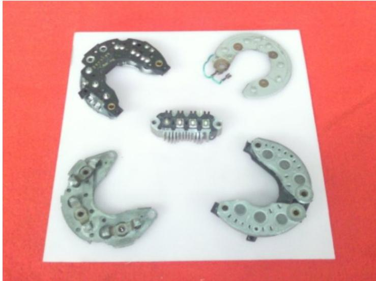
Compuesto por unas armaduras, una positiva y una negativa que sirven de soporte a los diodos.
