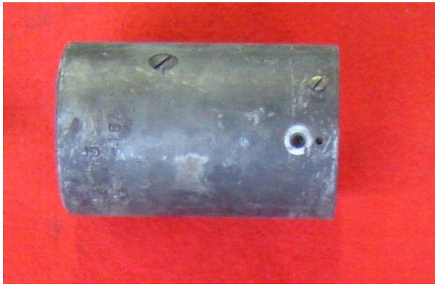
La carcasa, fabricada en acero de bajo contenido en carbono, forma el cuerpo del motor de arranque. Sobre esta, se monta el conjunto inductor.
