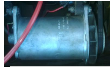
Generador de corriente continua (dinamo)
