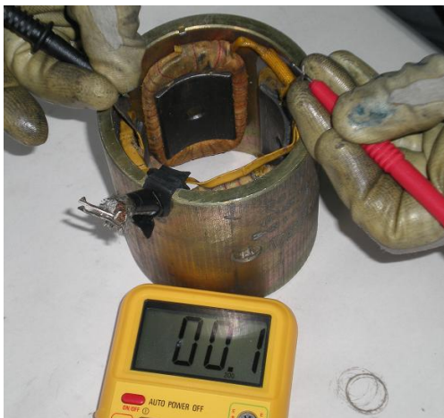
Continuidad de las bobinas inductoras
