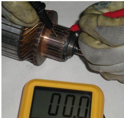
Continuidad de las bobinas inducidas
