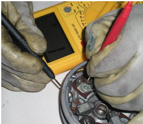
Aislamiento a masa de los portaescobillas positivos
