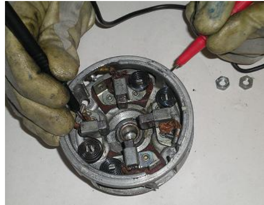
Continuidad a masa de los portaescobillas negativos
