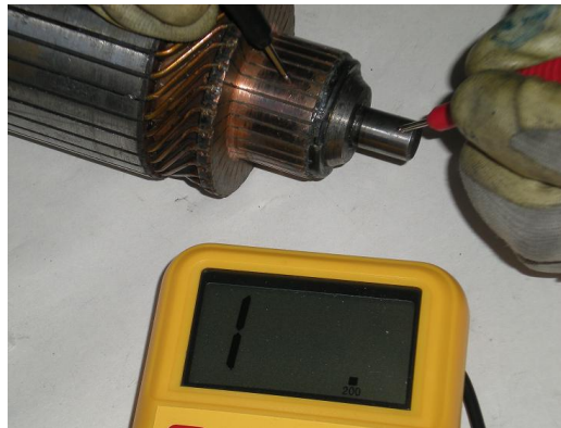
Aislamiento a masa de las bobinas inducidas
