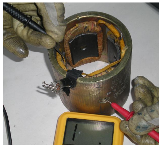
Aislamiento a masa de las bobinas inductoras
