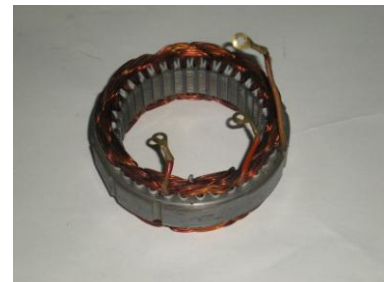
Estator de un alternador
