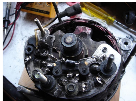
Puente rectificador de diodos
