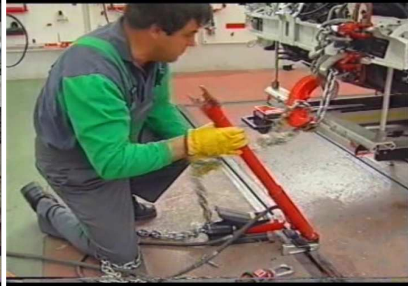
(Fig 2) Se coloca el anclaje
