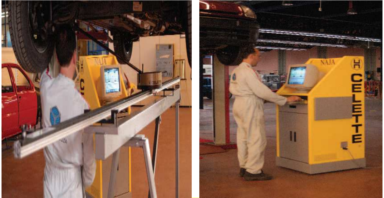
Sistema de medición Electrónico Naja de Celette, montado sobre el soporte gazelle que permite medir con el vehículo en el elevador
