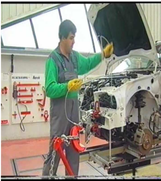
(Fig. 3) Colocación de eslingas
