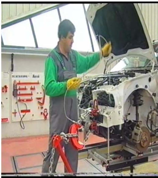
(Fig. 3) Colocación de eslingas
