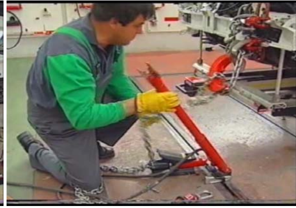
(Fig 2) Se coloca el anclaje
