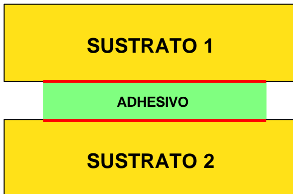
Fig.2: Esquema básico de una unión adhesiva.
