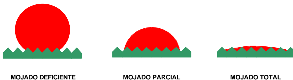
Fig.10: Ejemplos de diferentes mojados superficiales.
