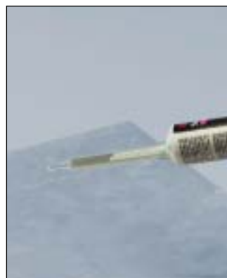
Accionar el gatillo para obtener y dispensar la cantidad deseada de producto mezclado.
