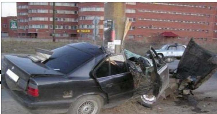
Cuando se doblan los largueros del bastidor y otros paneles de refuerzo de la carrocería, los daños en la carrocería impedirán que los largueros vuelvan a su forma original. En este caso, hay que efectuar las correcciones en el bastidor y los paneles de carrocería al mismo tiempo, en especial en las carrocerías unitarias en donde los largueros delanteros del bastidor están soldados por puntos en las tolvas internas y soporte del radiador.
