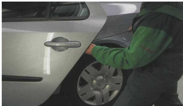
Este método de reparación se caracteriza por restablecer el estado original de la chapa sin dañar las capas exteriores de pintura.
