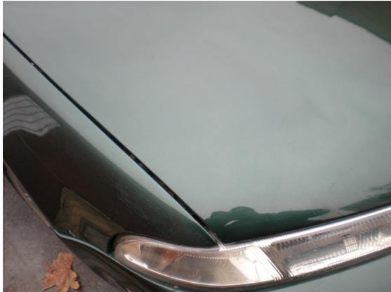
Así queda el capó después de realizar la reparación mediante ventosas adhesivas.
