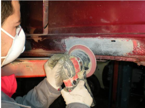
Se lija la masilla con lijadora excéntrica de accionamiento neumático.
