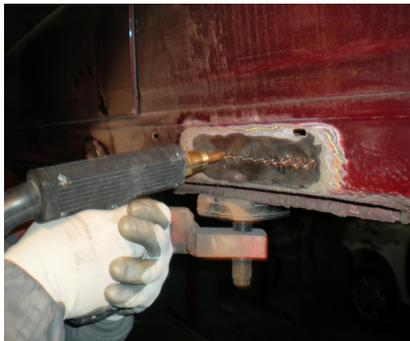
Mediante maquina multifunción se suelda el alambre en espiral en la chapa desnuda.
