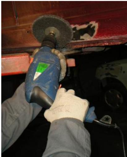
Eliminación de pintura, masilla o protecciones anticorrosivas. Mediante disco de carbono.
