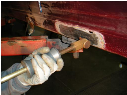
Mediante pistola, el martillo de inercia junto con la estrella de cobre se soldaran puntos (en las zonas más hundidas) y se realizaran tiros hacia atrás.
