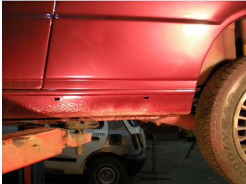
Deformación en un estribo bajo puerta.
