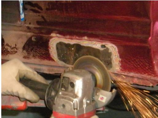
Utilizando la radial se eliminarán los restos de los puntos de soldadura producidos por el alambre en espiral y la estrella.
