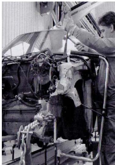
13- Tras haber extraído el daño de la punta del larguero, se procederá al montaje de una sonda de control en el alojamiento situado en la zona mas extrema del larguero así se posicionara finalmente el larguero delantero
