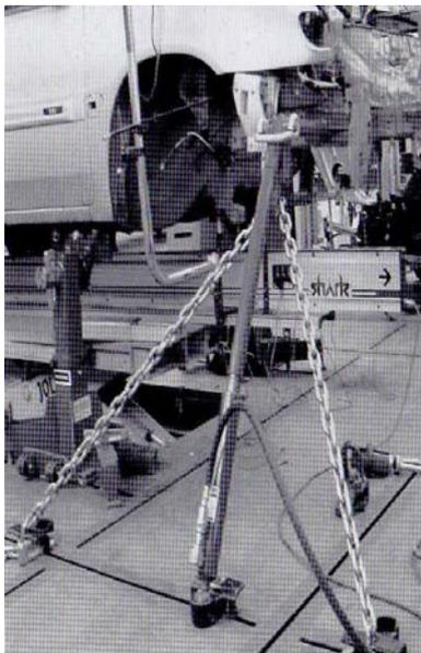
15- Conformados ambos largueros y cuadrados el hueco motor, se procede a la sustitución de aquellos elementos que lo requieran. Se comienza con el saneado del larguero delantero izquierdo, preparándolo así para sustituir la sección anterior del pase de rueda el cierre y el cierre frontal del larguero.
