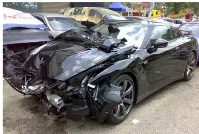
1- Antes de comenzar es necesario extraer toda la mecánica que nos moleste en la reparación. De esta manera se tendrá buen acceso tanto a las puntas de medición requeridos como en la zona en la que se realizan las operaciones de estiraje, reparación y sustitución de piezas.
