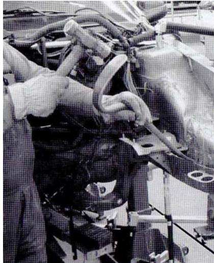
12- De la misma forma la arruga en la chapa salpicadero debe ser recuperado, recurriendo al martilleo de la zona afectada. Combinando el martilleo con el uso de la palanca, se soluciona la arruga detectada en esta zona.
