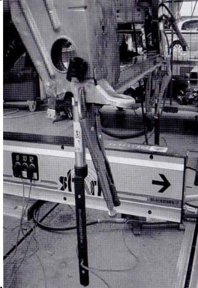
14- Una vez conformado el larguero delantero izquierdo se procede a la conformación del larguero derecho; para ello se plantea un tiro lateral al vehículo dando forma a esta pieza en anchura y longitud.
