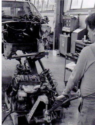
2- Tras la extracción de los conjuntos mecánicos el vehículo se sitúa encima de la bancada. Una vez elevado se sujeta con mordazas en los raíles de la bancada.
