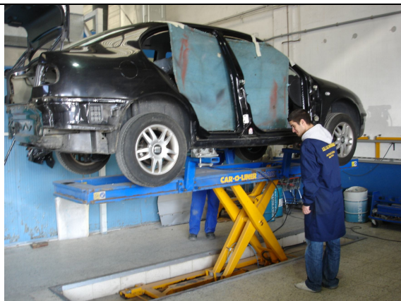
Anclaje y elevación del vehículo
