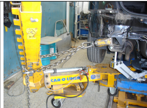
Realización del tiro, conformando la zona dañada.
