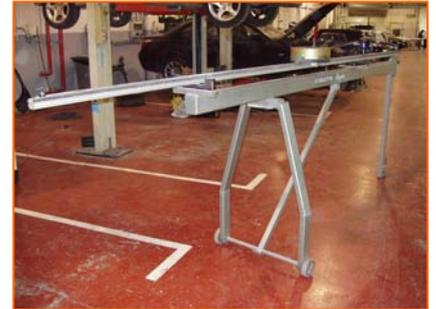
➤ Antes de realizar la medición, se debe establecer la comunicación entre el brazo medidor y el ordenador, para lo que se sitúa el brazo en un extremo del raíl y se presiona el pulsador. En ese instante, aparece en la parte superior derecha de la pantalla del ordenador un círculo blanco y negro, en constante movimiento, como reflejo de esa comunicación.
