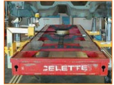
➤ Dispone de una serie de elementos de fijación, que permiten su anclaje a la bancada, aunque también se puede fijar sobre un carro móvil, denominado *Gazelle*, para efectuar la medición sin necesidad de disponer de una bancada.
