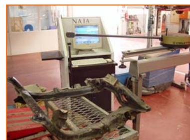
2. Las aplicaciones informáticas, que permiten un tratamiento de la información obtenida en la medición. El ordenador dispone del software característico de cada fabricante que permite comparar con facilidad las medidas del fabricante con las del vehículo, contando con los periféricos y la impresora.
