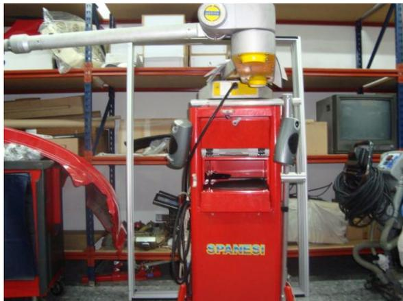
**Armario de trabajo y almacenamiento:** El armario de trabajo aloja el brazo medidor y un juego de prolongadores y adaptadores de rápido ensamblaje, que sirven de conexión entre los puntos de medida del vehículo y el brazo medidor.
