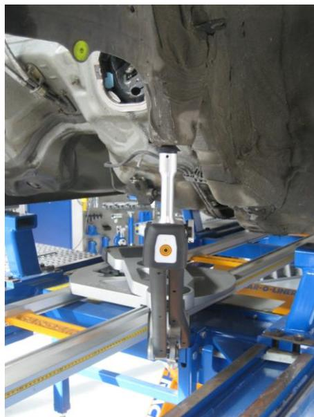
**Características:** El medidor CAR-O-TRONIC ofrece la posibilidad de realizar el análisis y el diagnóstico de las medidas del vehículo siniestrado antes de colocarlo sobre el banco de enderezado, ya que puede ser utilizado, en un elevador normal, gracias a la utilización de un soporte diseñado a tal efecto.
