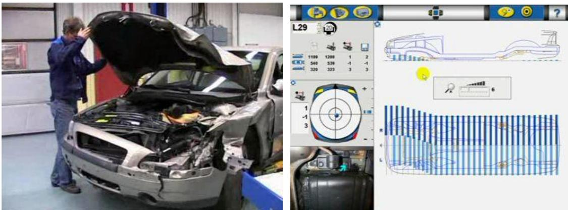
De todas maneras, la utilización de equipos de medición electrónica en la reparación de las carrocería, es un gran avance ya que nos ofrece ahorro de tiempo en las reparaciones, en una mejor comprobación de puntos, ya que son mas exactos, y no tener que trabajar con equipos de medición pesados que ralentiza mucho el trabajo debido a la dificultad de su movilidad.
