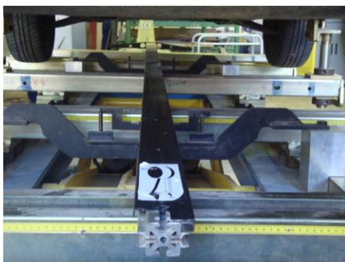
**Cabezal y Brazo de medida:** La medición se lleva a cabo mediante el accionamiento del pulsador montado en el cabezal. El cabezal de medida lleva incorporado una batería y trabaja mediante radiofrecuencia inalámbrica con respecto al ordenador, ambos disponen de una antena de radiofrecuencia. Y un brazo de medida principal
