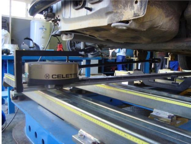
Proseguimos seleccionando en el programa informático, el modelo de vehículo a comprobar, indicando si se realiza con mecánica o sin mecánica montada, diferenciando también entre el desmontaje de la mecánica de la parte delantera o de la parte trasera. Nosotros optamos por desmontar solamente las ruedas traseras, pues nos parecía suficiente para realizar las tareas que nos habíamos marcado.
