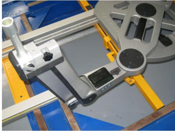
**Su funcionamiento:** El brazo es desplazado sobre el carro situado en la parte inferior del vehículo hacia cada uno de los puntos que se desea controlar. El ordenador registra todos y cada uno de los movimientos del brazo de medición en el recorrido de la localización de puntos de referencia geométrica en la carrocería.
