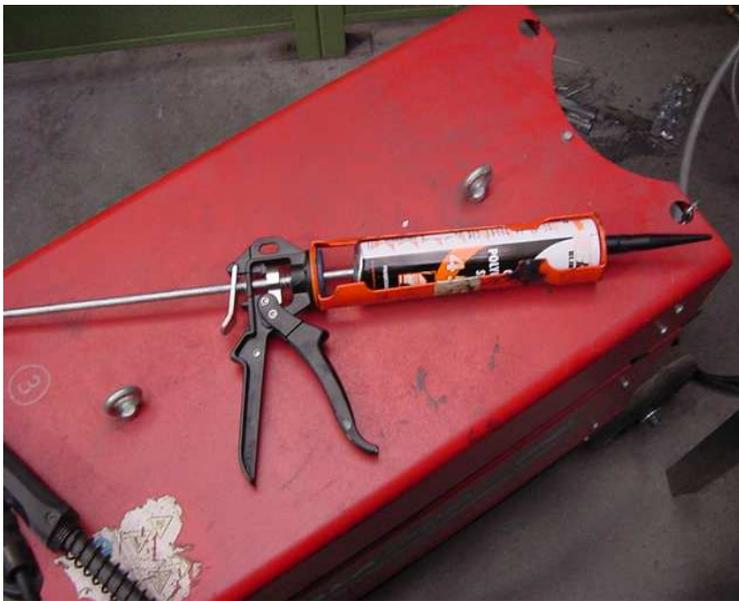
Los poliuretanos pueden ser monocomponentes (1K) o bicomponentes (2K).
