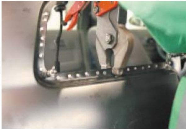
Remachado en una carrocería de aluminio
