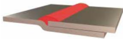
SOLDADURA CON SOLAPE
