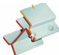
Unión mediante remache estampado.
