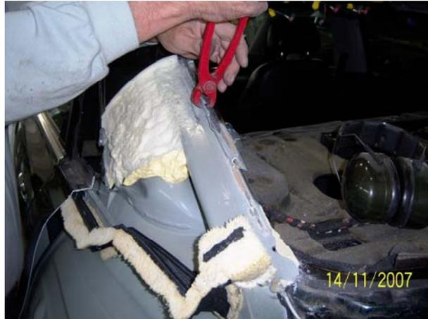
**Séptimo paso:** consiste en medir la aleta nueva, marcarla con una punta de trazar y ponerle una cinta de carrocerero por donde hay que cortar la aleta, y realizarle los cortes necesarios con la sierra de vaivén. Para esta operación utilizaremos el método indicado para cualquier sustitución parcial de una carrocería común.
