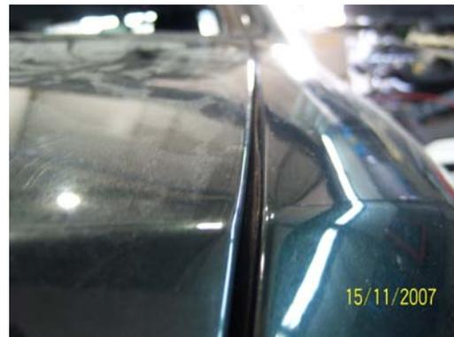
**Décimo paso:** Lijamos para quitar la pintura en aquellos lugares donde vamos a soldar. A continuación se aplica pegamento de dos componentes a la tira que realizará el empalme, debido a que seguidamente se va a remachar al trozo de aleta que se encuentra fija en el vehículo, cuando se le aplica el pegamento, se aguanta con los gatillos de sujeción y se va quitando un gatillo por cada remache que se pone con la remachadora neumática.
