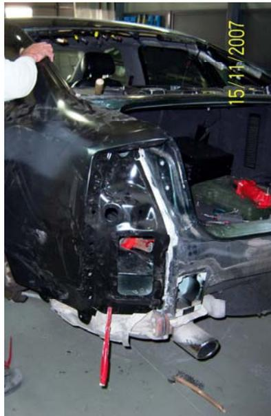
**Octavo paso:** A partir de aquí procedemos a la sujeción de la aleta, a la cual le realizamos unos agujeros a medio centímetro del borde y respetando el diámetro de los remaches (en este caso, de cinco milímetros), y después sujetamos la pieza, que entra unos dos centímetros en el interior de la pieza, y procedemos a taladrar la pieza del empalme.
