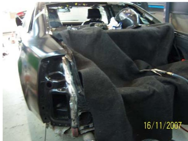
Después se pasa al calibrado de la máquina de soldar (Mig-Mag), a este proceso se le da la potencia y velocidad de hilo necesario soldar en el vehículo, debido al grosor del material y a la zona que se va a soldar. Se hacen pequeños cordones continuos, y a
