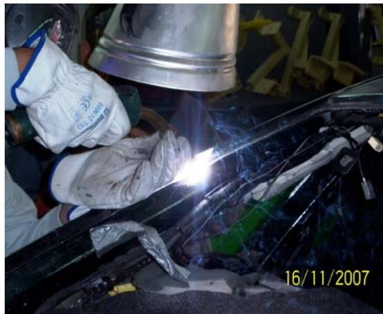
**Paso décimo tercero:** se rebajan con un disco de desbaste las cabezas de los remaches que quedan en la superficie del empalme y se repasa la soldadura sin llegar a debilitarla.
