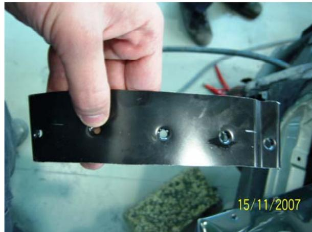
A continuación, comprobamos sobre el vehículo el corte realizado, contrastando la aleta cortada con el corte hecho en la carrocería para ver si se ajustan.
