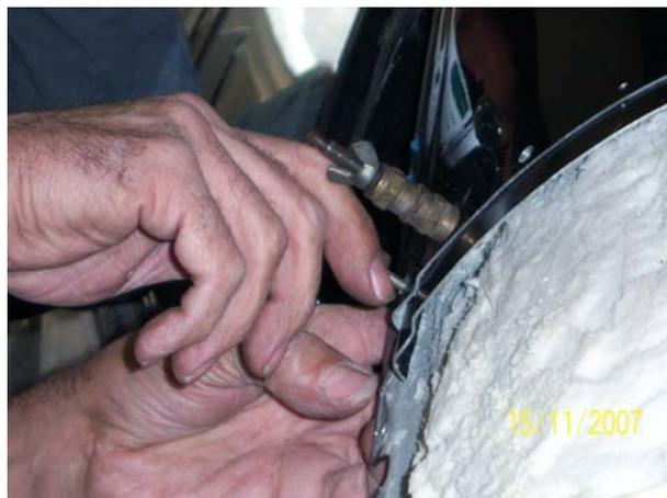
**Noveno paso:** necesitamos colocar el portón trasero y presentarlo, en los bordes y esquinas, se observa que las separaciones y aperturas estén dentro de las tolerancias marcadas por la documentación, medidas entre el maletero y la aleta antes de pasar a las uniones por soldadura y remaches.
