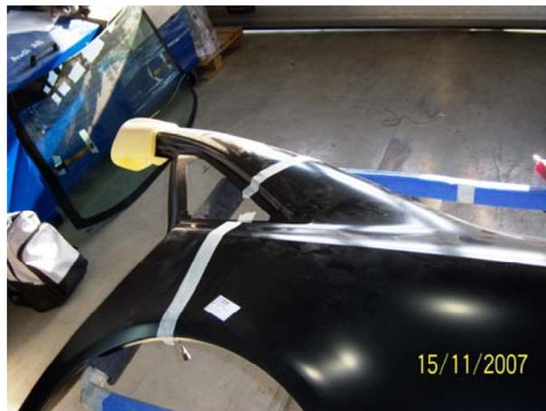
Seguidamente se corta una tira de cuatro centímetros de ancho y el largo que da la pieza. Esto se realiza sobre un retal de la pieza nueva, a continuación del último corte realizado que sirve para hacer el empalme de las dos piezas, la de la aleta fija con la aleta nueva, que vamos a sujetar con unos remaches.
