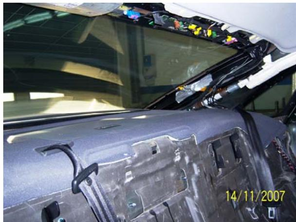
**Segundo paso:** se trata del desmontaje del maletero, de su instalación eléctrica de las luces y de dos antenas instaladas en su superficie, para ello, hay que desenchufar las clavijas de los pilotos, quitar las luces de matrícula y la tercera luz de freno para poderlos desenchufar. Desmontamos las dos antenas que están en la superficie del maletero, que contiene dos cables bastante más gruesos. Agrupar todos los cables y sacarlos por la estructura del maletero por el que están metidos.
