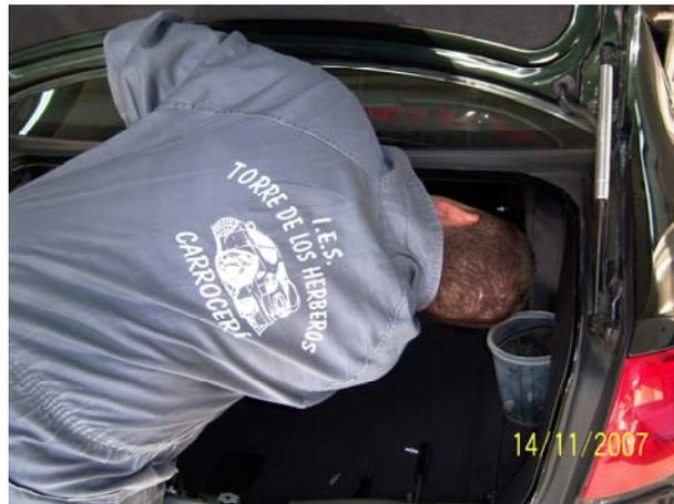
**Tercer paso:** consiste en separar las centrales electrónicas, como la del ESP, del interior de la aleta que se va a sustituir; desmontar el guarnecido izquierdo del interior del maletero y quitar los tornillos que sujetan las centrales electrónicas. Separarlas todo lo que dé el cable, para que no haya peligro de porrazos a la hora de estar trabajando.
