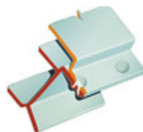
Unión mediante remache estampado.
