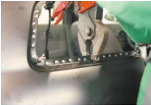
Remachado en una carrocería de aluminio
