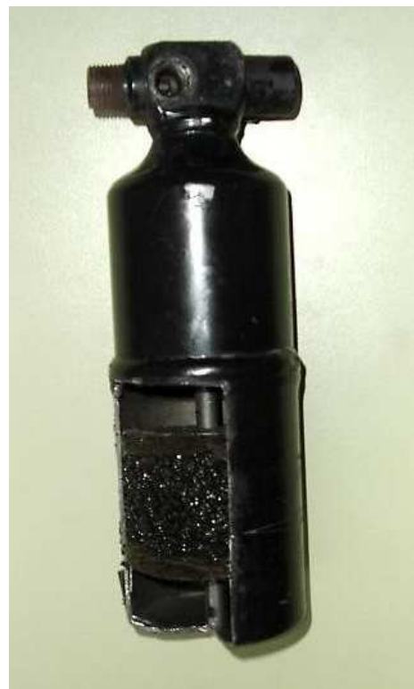
Filtro deshidratador seccionado con carbón activo
