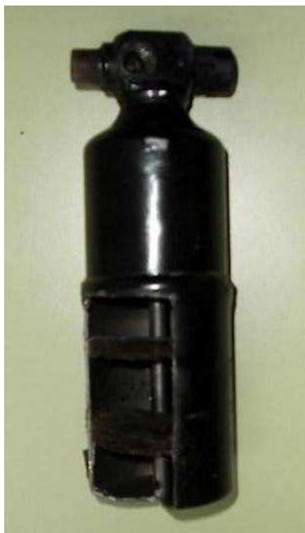
Filtro deshidratador seccionado
