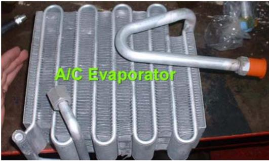
El evaporador está localizado dentro del vehículo, y sirve para absorber tanto el calor como el exceso de humedad dentro del mismo. En el evaporador el aire caliente pasa a través de las aletas de aluminio unidas a los tubos; y el exceso de humedad se condensa en las mismas, y el sucio y polvo que lleva el aire se adhiere a su vez a la superficie mojada de las aletas, luego el agua es
