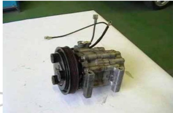
Los compresores de pistones alternativos, constan de entre cinco o siete pistones posicionados de forma horizontal y en su interior están los émbolos que comprimen al agente frigorífico que se encuentra en estado gaseoso dentro de los cilindros del compresor. El movimiento giratorio se transmite mediante una correa que arrastra la polea del compresor, esta
