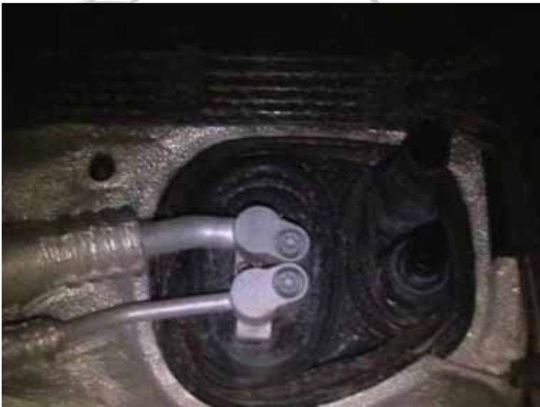
Aquí tenemos una válvula de expansión en su propio alojamiento en el vano motor.
