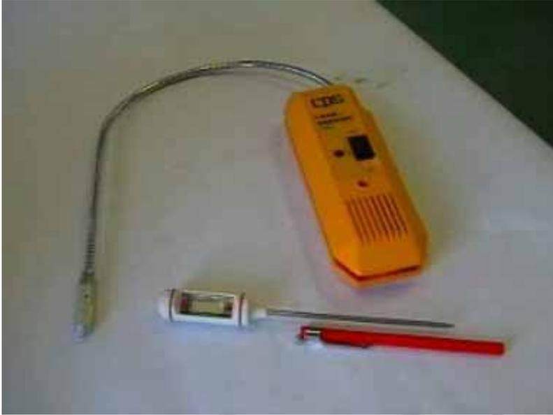
Termómetro digital y detector de fugas.
