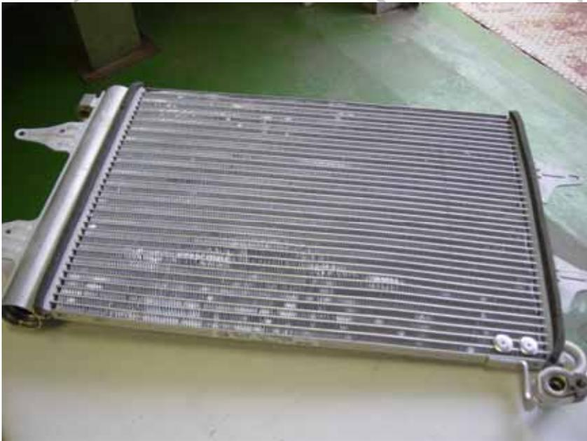
La función del condensador es evacuar el calor que el agente frigorífico ha adquirido debido a su aumento de presión en el compresor, pasando así de estado gaseoso a alta presión a estado
