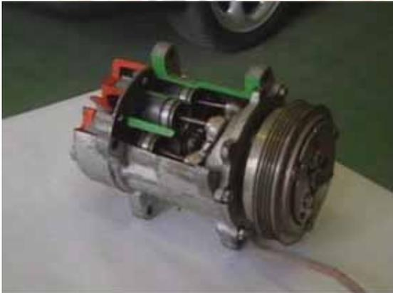
polea se hace solidaria al eje mediante un embrague electromagnético. Cuando está embragado, un disco oscilante que tiene un movimiento giratorio empuja a los pistones consiguiendo de esta forma un movimiento alternativo. Para cada cilindro tendremos dos válvulas, una aspirante y otra impelente.
