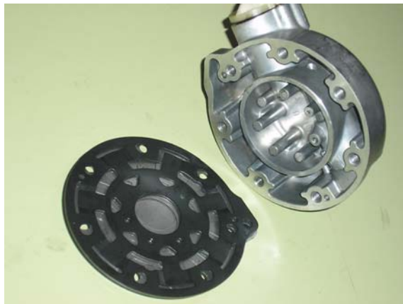
Placa de válvulas y culata del compresor
