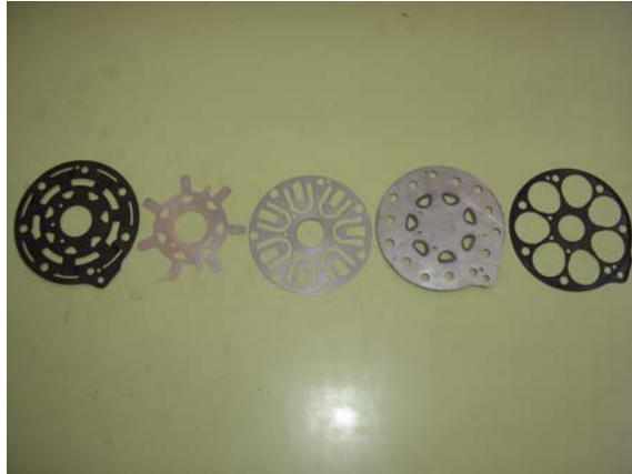
Despiece de la placa de válvulas
