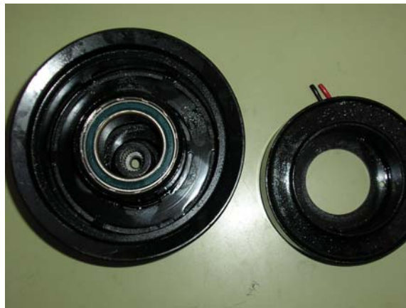
Polea y bobina del electroembrague
