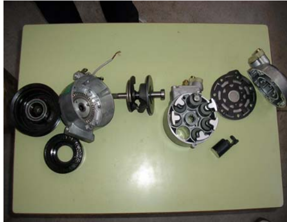
Despiece parte por parte del compresor de geometría variable
