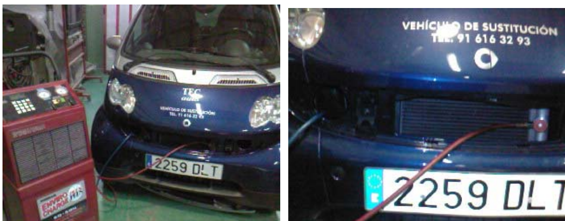
Carga de A/A en un Smart.
