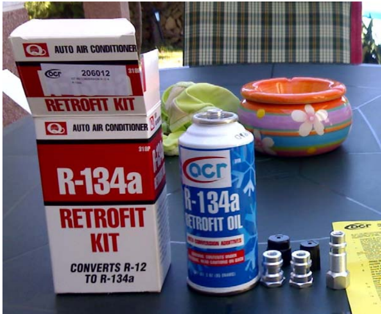
Kit de aceite lubricante para convertir los circuitos de gas R12 a R134a
